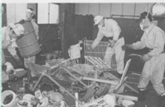
▲可茂衛生センターでは、手作業で不燃物を仕分けする。1本のスプレー缶が、彼らの身に危険を及ぼすことにもなりかねない。
